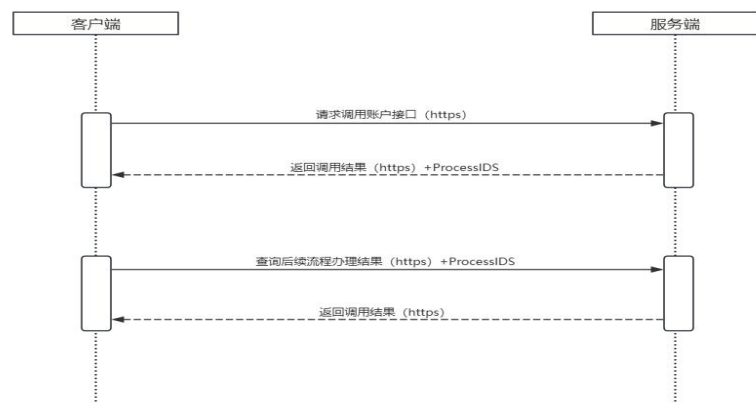
图2 通信交互模式_请求_应答（有后续报送流程）
